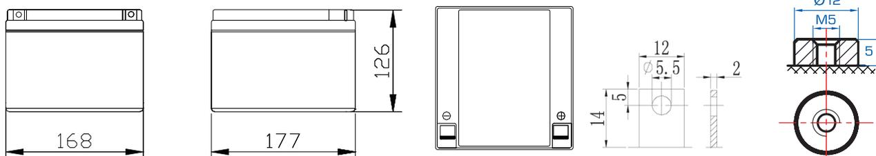
F13 (Schraubanschluss M5)
